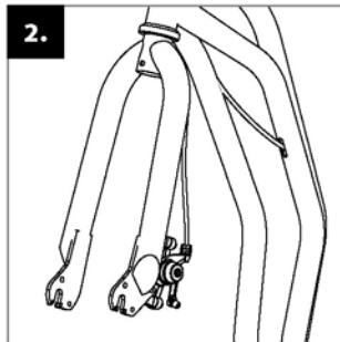
Zorg ervoor dat de voorvork van de step goed geïnstalleerd is en zorg dat het goed is gecentreerd.
