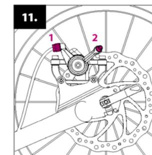
La distance entre les pads et le disque doit être la plus petite possible. Vous pouvez l'ajuster avec la petite roulette (1) qui règle la tension du câble de frein. Si cela ne suffit pas tendez ou détendez le câble de frein au niveau de la vis d'ancrage (2).
