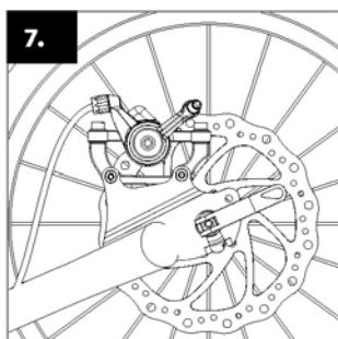
**Montáž zadního kola se od montáže předního neliší.** Zopakujte proto stejný postup.
