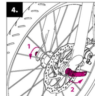
Dotiahnite maticu **(1)** tak, aby ste pred dotiahnutím (sklopením) rýchlopínajacej páčky cítili odpór. Páčku dotiahnite **(2)** (sklopte) do polohy v ktorej bude smerovať k zadnému kolesu (z bezpečnostných dôvodov).
