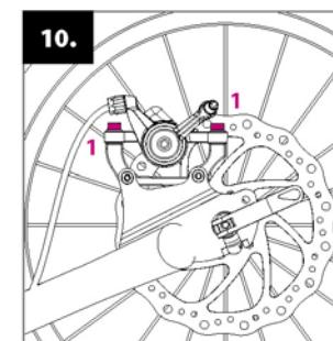
**Nastavenie bŕzd:** na obidvoch kolesách skontrolujte, či sa kotúč brzdy pri roztočení kolieska nedotýka brzdovej platničky. Pokiaľ áno, povoľte nastavovacie skrutky **(1)** a nastavte polohu obidvoch platničiek tak, aby boli po celej svojej ploche rovnobežne s kotúčom brzdového disku a potom dotiahnite nastavovacie skrutky.
