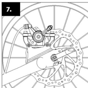
**A hátsó kerék szerelése** azonos az első kerék szerelésével. Ismételje meg ugyanazt az eljárást.
