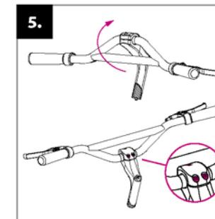
**Installation av styre:** Placera styrröret som visas på bilden och dra åt skruvorna på ramen.
