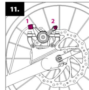
Der Abstand der Bremsbeläge von der Bremsscheibe sollte minimal sein. Sie können diesen Abstand mit Hilfe der Justierhülse (1) durch Veränderung der Spannung des Bremsseiles einstellen. Sollte der Verstellbereich nicht ausreichen, spannen oder lockern Sie das Bremsseil an der Ankerschraube (2).
