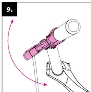
**Einstellen der Bremshebel:** stellen Sie die richtige Lage der Bremshebel am Lenker mit Hilfe der Klemmschraube des Bremshebelhalters ein.
