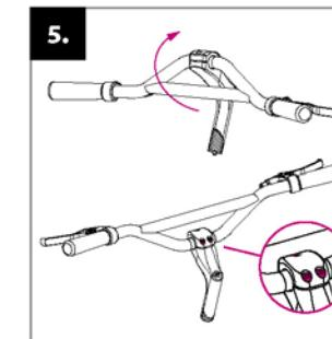
**Installation du guidon:** placez le tube du guidon comme sur la photo et resserrez la vis sur la tige.
