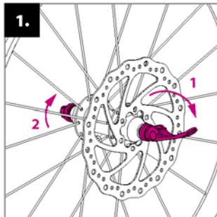
**Возьмите переднее колесо:** поверните рычаг эксцентрика (1), как показано на рисунке и ослабьте гайку (2).
