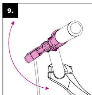
**Nastavenie brzdových páčiek:** nastavte správny sklon brzdových páčiek pomocou upevňovacej skrutky na objímke.
