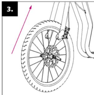
Führen Sie die Radachse von unten in die Schlitze der vorderen Gabel, und positionieren Sie das Rad so, dass es genau in der Mitte ist.
