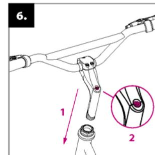
Inserte el manillar en el bastidor delantero (1) y ajuste la altura de acuerdo con las necesidades del ciclista (no superior a la indicada por la línea). Compruebe que el manillar está en posición vertical y ajuste correctamente el tornillo del tubo del manillar (2).
