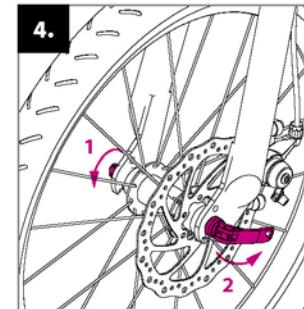
Закручивайте гайку (1) до тех пор, пока вы не почувствуете сопротивление при закрытии рычага эксцентрика (2). Закройте эксцентрик таким образом, чтобы рычаг эксцентрика был направлен к заднему колесу (из соображений безопасности).
