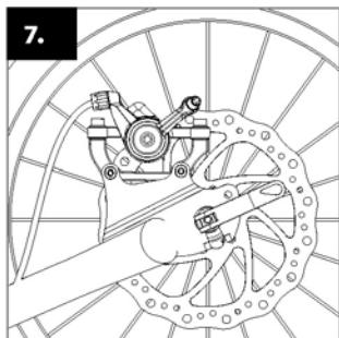
**Die Montage des hinteren Rades** erfolgt ident zur Montage des Vorderrades. Folgen Sie den gleichen Schritten wie in 1-4.
