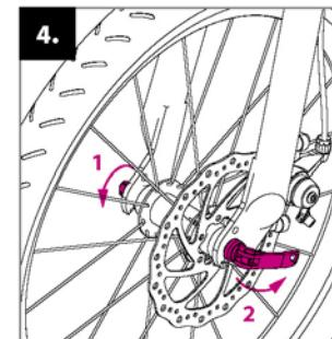
Húzza szorosra az anyát (1) úgy, hogy a gyorsszorító kar teljes bezáródása előtt ellenállást érezzen. Zárja be a kart olyan helyzetbe, amelynél a hátsó kerék (2) felé fog irányulni (biztonsági okokból).
