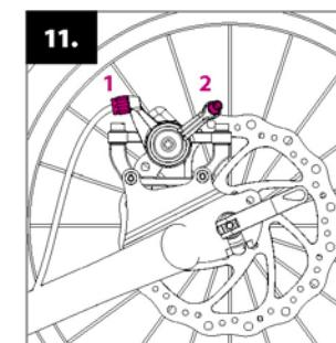
La distanza delle pastiglie dei freni dal disco dovrebbe essere minima possibile. È possibile impostarla utilizzando il rullo di regolazione (1) che regola la tensione del cavo dei freni. Se non è sufficiente, stringere o allentare il cavo nel dado di ancoraggio (2).
