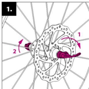
**Montaggio della ruota anteriore (la più grande):** allentare la leva di bloccaggio rapido del mozzo e allentare il dado.
