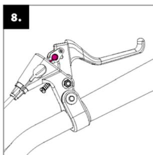
**Instalace brzdrových lanek:** zmáčkněte brzdrovou páčku na maximum a do kulatého očka vložte konec brzdrového lanka. Stejný postup zopakujte na obou páčkách.
