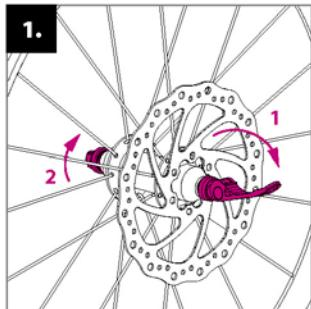
**Montage des vorderen, größeren Rades:** Öffnen Sie den Schnellspannhebel und lockern Sie die Gegenmutter etwas.
