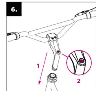
Zasuňte řídítkovou tyč do hlavové trubky rámu koloběžky (1) a nastavte požadovanou výšku řídítka (max. po vyznačenou rysku). Zkontrolujte, zda jsou řídítka rovně a dotáhněte šrouby na řídítkové tyče (2).
