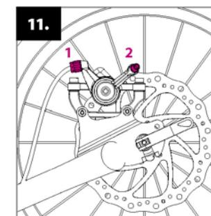
Avståndet mellan skiva och bromsbelägg ska vara minimalt. Du kan justera detta med justeringsmutter **(1)** med vilken man spänner bromskabeln. Om detta inte är nog, skruva åt eller lätta på bromskabeln vid förankringsskruven **(2)**.
