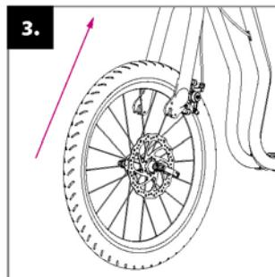
Coloque la rueda en la horquilla delantera, y asegúrese que queda bien centrada.
