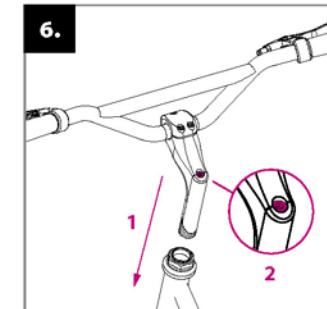
Schuif het stuur respectievelijk de stuurstang in de balhoofdbuis (1) stel de hoogte van het stuur in vanaf de grond volgens de behoeften van de gebruiker, waarbij de maximale uitschuifmogelijkheid gemarkeerd is op de stuurstang. Controleer of het stuur recht staat ten opzichte van het voorwiel en draai de bout op de stuurschroeven goed aan (2).
