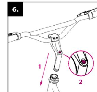
Sätt styrröret i ramen **(1)** och justera höjden beroende på användarens behov (ej högre än vad som anges av linjen). Kontrollera att styret är upprätt och ordentligt åtskrutat på styrröret **(2)**.
