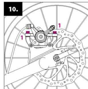
**Ajuste de frenos:** En ambas ruedas, compruebe que los discos no tocan las pastillas de freno cuando la rueda esté girando. Si realmente tocan, afloje los tornillos de ajuste (1) y regule la posición de ambas pastillas de freno de modo que sean paralelas al disco en su longitud. A continuación, apriete los tornillos de nuevo.
