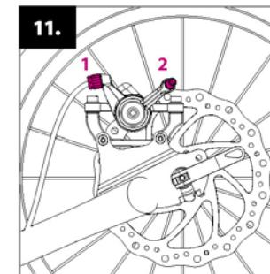
De afstand tussen de remblokjes en de schijf moet minimaal zijn. Dit kun je afstellen met de stelbout (1) waarmee je de spanning op de remkabel regelt. Als dit niet voldoende is kun je de remkabel afstellen met het ankerschroef (2).
