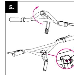
**Stuur montage:** Draai bij het stuur de stuurschroeven omlaag zoals afgebeeld op de foto en draai de 4 slotbouten van de stuurschroeven gelijkmatig aan.
