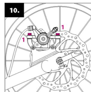
**Seřízení brzd:** Na předním i zadním kole zkontrolujte, zda kotouč brzdy při roztočení kolečka neškrťá o brzdrovou destičku. Pokud ano, povolte seřizovací šroubky (1) a nastavte polohu obou destiček tak, aby byly po celé své ploše rovnoběžné s kotoučem, poté seřizovací šroubky opět dotáhněte.
