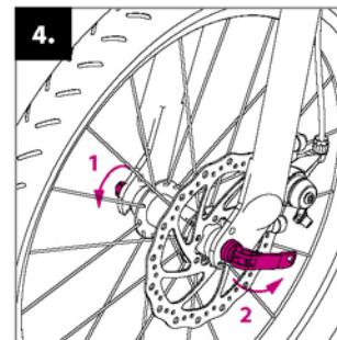
Apriete la tuerca (1) hasta que sienta resistencia antes de cerrar el cierre rápido. Cierre de manera que la palanca del cierre rápido señala hacia arriba (2) (por razones de seguridad).
