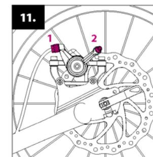
Vzdialenosť brzdových platničiek od kotúča by mala byť čo najmenšia. Upraviť ju môžete pomocou nastavovacieho valčeka **(1)**, ktorým sa upravuje napätie brzdového lanka. Pokiaľ to nestančí, dotiahnite, alebo povoľte lanko v kotviacej skrutke **(2)**.
