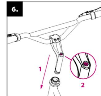
Schieben Sie die Lenkerstange in das Hauptrohr des Tretrollerrahmens (1) und stellen Sie die gewünschte Höhe des Lenkers ein (bis max. in Höhe des gekennzeichneten Striches). Überprüfen Sie, ob der Lenker gerade ist und ziehen Sie die Inbusschraube der Lenkerstange fest (2).
