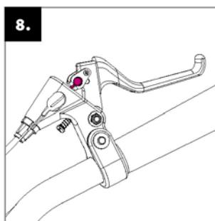
**Inštalácia brzdových laničiek:** stlačte brzdovú páčku na maximum a do okrúhleho očka vložte koniec brzdového lanka. Rovnaký postup zopakujte na oboch páčkach.
