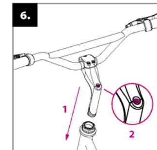
Zasuňte tyč riadenia do hlavovej trubky rámu kolobežky **(1)** a nastavte požadovanú výšku riadiacich (max. po vyznačenú rysku). Skontrolujte, či sú riadiidlá rovno a dotiahnite skrutku na tyči riadenia **(2)**.
