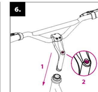
Insérez le tube du guidon dans la fourche avant (1) ajustez la hauteur en fonction de l'utilisateur (pas plus haut que le trait sur le tube). Vérifiez que le guidon est droit et serrez soigneusement la vis en haut du tube (2).
