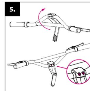
**Instalación del manillar:** coloque el manillar como se muestra en la imagen y apriete los tornillos en la tija.
