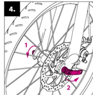
Drehen Sie die Schraubenmutter (1) nun so nach, dass sie vor dem Schließen des Schnellspannhebels einen Widerstand fühlen. Schließen Sie den Hebel so, dass er nach hinten geklappt ist (2) (aus Sicherheitsgründen).
