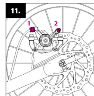
Vzdálenost brzdrových destiček od kotouče by měla být co nejmenší. Nastavit ji můžete pomocí seřizovacího válečku (1), který upravuje napětí brzdného lanka. Pokud to nestačí, přitáhněte, případně povolte lanko v kotevním šroubku (2).
