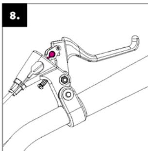
**Montage der Bremszüge:** ziehen Sie den Bremshebel auf das Maximum an und schieben das verdickte Ende des Bremsseils in die Mitnehmerhalterung. Wiederholen Sie den gleichen Vorgang bei beiden Hebelen. Der hintere Bremsbowenzug wird in der Regel in den rechten Bremshebel befestigt, das Vordere in den linken Bremshebel.
