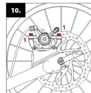
**Ajustement des freins :** sur les 2 roues, assurez vous que le disque ne touche pas les pads de frein quand la roue tourne. Si oui, desserrez les vis d'ajustement (1) et régler la position des 2 pads afin qu'ils soient parallèles au disque sur toute la longueur. Revissez ensuite les vis.
