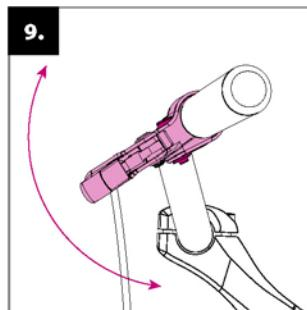
**Ajuste de las palancas de freno:** incline las palancas de freno correctamente aflojando el tornillo de la maneta.
