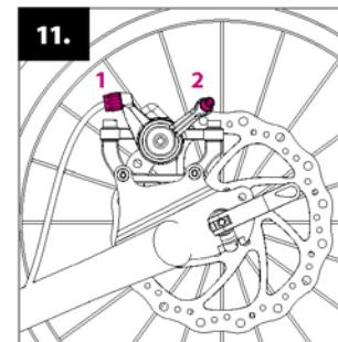
La distancia entre las pastillas y el disco debe ser la mínima. Puede ajustar con la tuerca de ajuste (1), que regula el la tensión del cable de freno. Si este no es suficiente, apriete o incluso afloje el cable del freno al anclar el tornillo (2).
