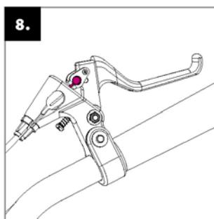
**Installation des câbles de frein:** appuyer sur le levier de frein à fond. Et insérez la fin du câble dans le point de fixation circulaire. Répétez la même chose avec les 2 câbles.
