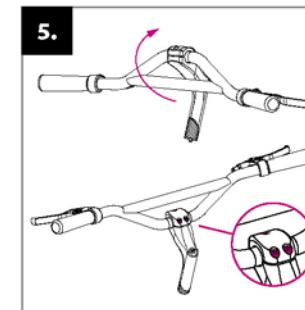
**A kormány felszerelése:** helyezze a kormányrudat a kép szerinti helyzetbe, és húzza meg a szár csavarjait.
