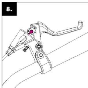
**Installatie van remkabels:** Schuif het ronde uiteinde van de remkabel in het grotere ronde gat aan de onderkant van de remhendel. Herhaal dit bij de andere remkabel.
