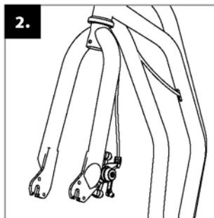
Kontrollera att framgaffeln på sparkcykeln är i rätt position (bromsskivan är placerad på vänster sida i åkriktningen).
