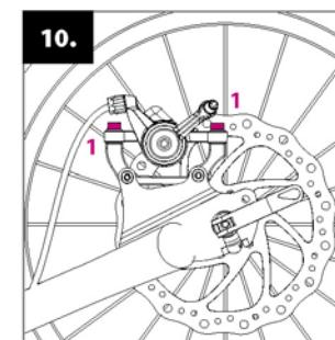
**Justering av bromsar:** på båda hjulen, kontrollera att bromsskivorna inte berör bromsbelägggen när hjulet snurrar. Om så är fallet, lossa justeringsskruvarna **(1)** och reglera båda bromsbeläggens position så att de ligger parallellt med skivan hela vägen. Sedan skruva åt justeringsskruvarna.
