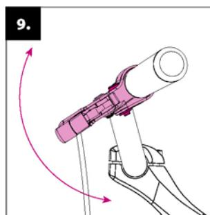
**Seřízení brzdrových páček:** nastavte správný sklon brzdrových páček pomocí upevňovacího šroubu na objímce.
