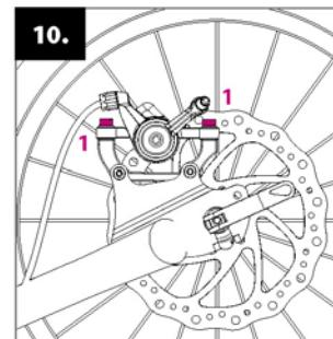
**Einstellung der Bremse:** überprüfen Sie auf beiden Rädern, dass die Bremsscheiben die Bremobeläge beim freien Drehen des Rades nicht berühren. Falls doch, lösen Sie die Justierschrauben (1) und stellen die Abstände der beiden Bremsklötze so ein, dass diese über die gesamte Länge parallel zur Bremsscheibe sind. Danach fixieren Sie die Justierschrauben wieder.
