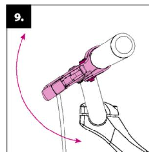
**Ajustement des leviers de frein:** incliner le levier de frein correctement en desserrant la vis sur le manche.
