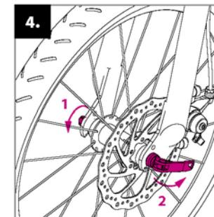
Avvitare il dado (1) finché non si incontra una certa resistenza prima di fissare la leva del bloccaggio rapido. Fissare la leva di modo che sia rivolta verso la ruota posteriore (2) (per motivi di sicurezza).
